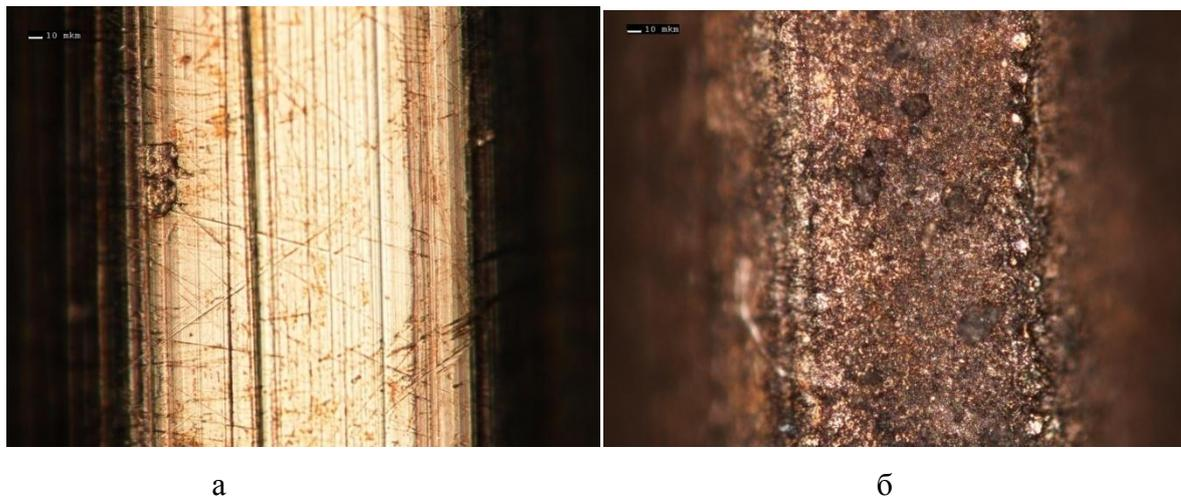
Рис. 6 Фотографии участка поверхности медного образца вблизи центральной кромки до облучения (а) и после облучения  $5 \cdot 10^4$  импульсами (б) при величине импульсного нагрева  $250^\circ\text{C}$ . Фотографии получены с помощью оптического микроскопа.
