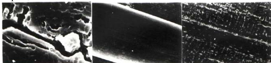
Рис. 22. Структура подповерхностного слоя образца отожженного сплава VT-6 после наработки 25% долговечности: а) X30; продольные макротрещины, б) X300; система продольных и поперечных микротрещин; в) X5000; распространение трещин по границе \alpha -фазы.
