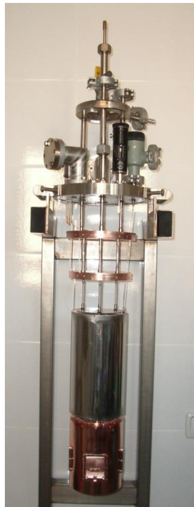
Рисунок 3.3 - Схема криостата и его фотография
