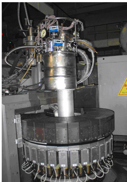
Рисунок 4.15 - Расположение криостата на дифрактометре ДИСК на реакторе ИР-8 [А7]. 1 – криостат, 2 – биологическая защита, 3 – коллиматор, 4 – детектор, 5 – юстировочный стол, 6 - уровень, ниже которого располагается образец
