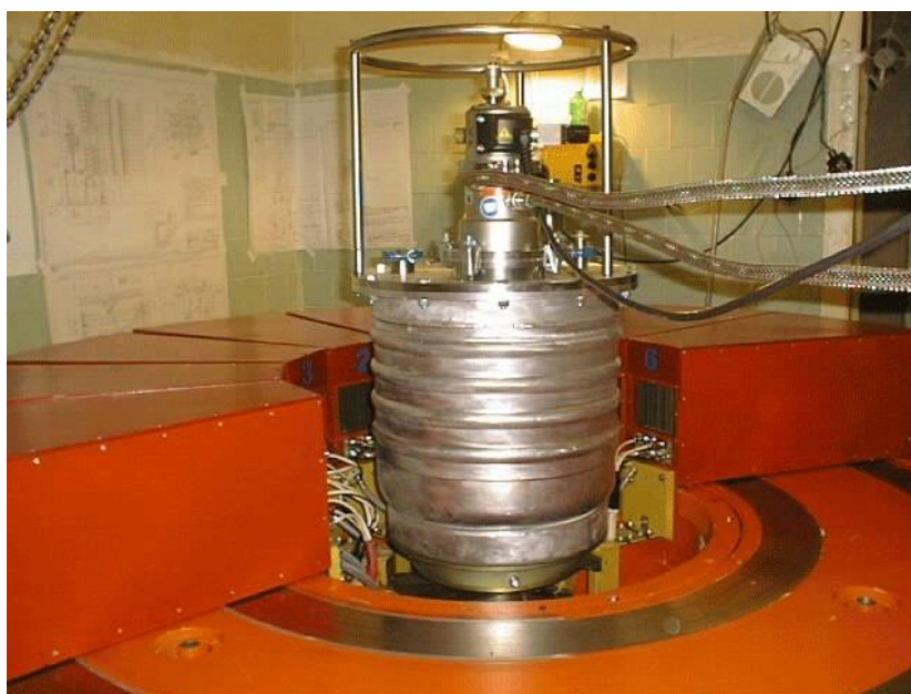
Рисунок 4.4 – Фотография криостата на ПДК
