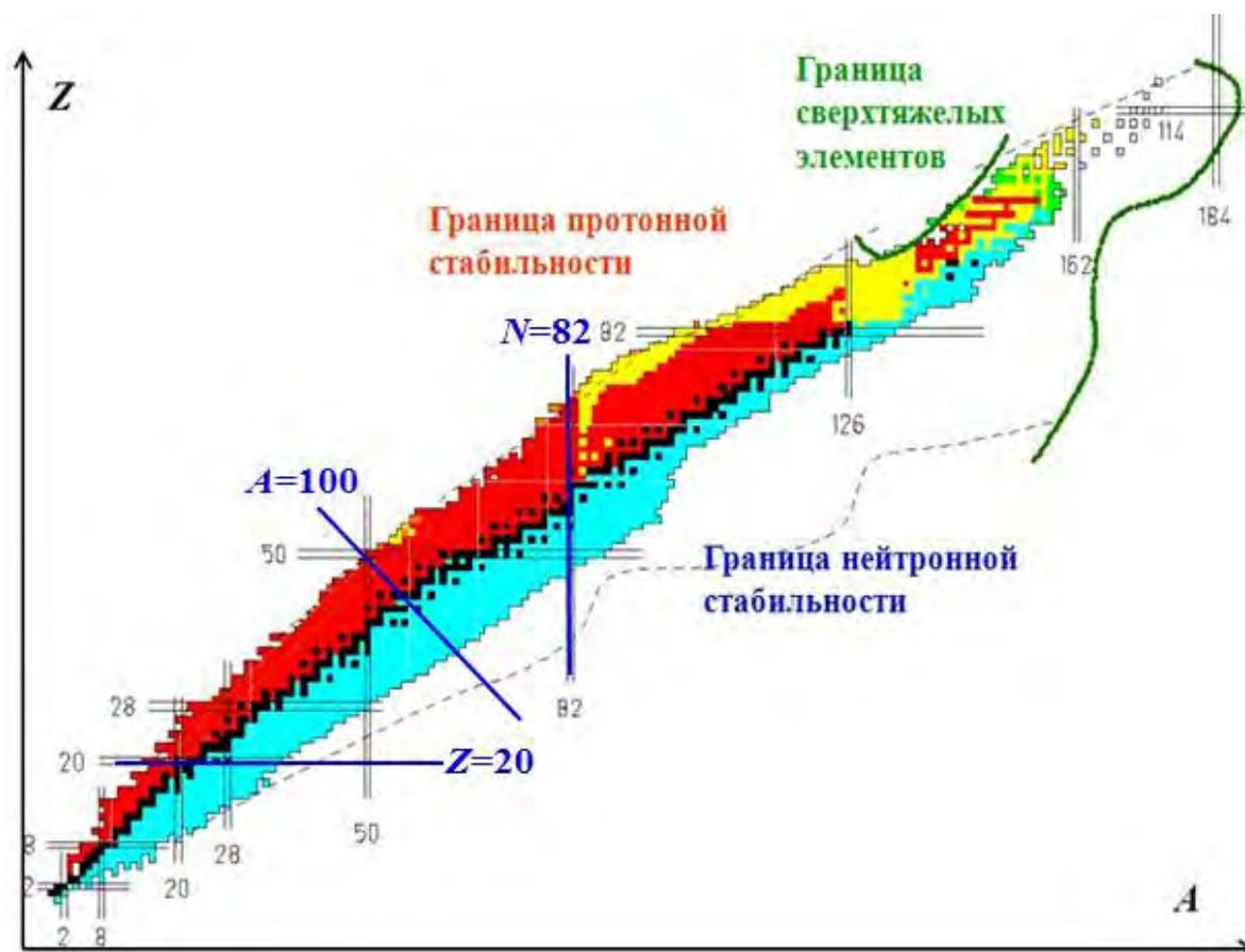
Рис.1. Карта ядер с указанием границ протонной и нейтронной стабильности. Полосами выделены ядра с замкнутыми оболочками по нейтронам или протонам. Цепочки ядер с одинаковыми значениями  $Z$ ,  $N$  и  $A$  являются изотопами, изотонами и изобарами; для  $Z=20$ ,  $N=82$  и  $A=100$  они обозначены горизонтальной, вертикальной и диагональной илиниями, соответственно.
