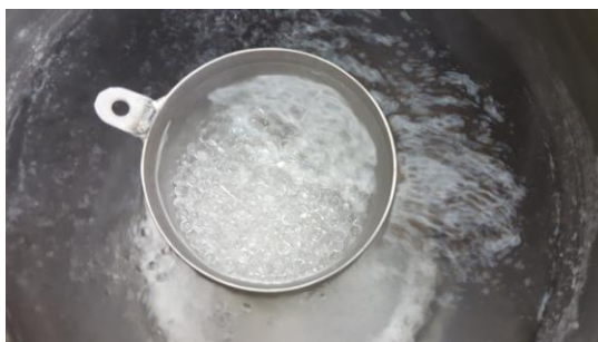
Рисунок 18. Готовые просеянные шарики в азоте перед загрузкой
