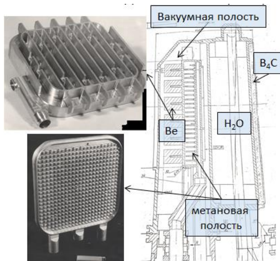
Рисунок 11. Вертикальный разрез метанового замедлителя СМ-2 с фотографиями стенки для намораживания метана и места установки бериллиевой решетки.
