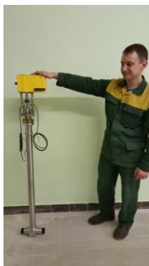
Рисунок 65. Криогенный вентиль фирмы «STOHR» с электроприводом, примененный в коллекторе для распределения гелия.
