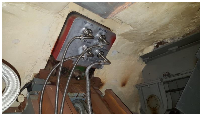
Рисунок 32. Рабочее положение замедлителя в каньоне, шибер открыт.
