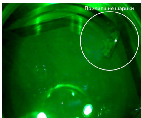
Рисунок 35. Шарик прилип к рассеивателю имитатора камеры на полномасштабном стенде КЗ 202 при температуре в камере 150 К.
