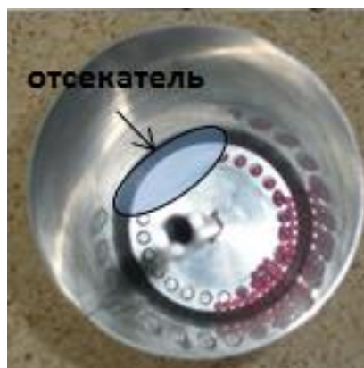
Рисунок 52. Внутренняя часть дозатора – вид сверху на диск и отсекатель.
