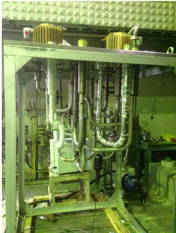
Рис. 95. Криостат с теплообменником и двумя газодувками в верхней части криостата. Вакуумный кожух снят.
