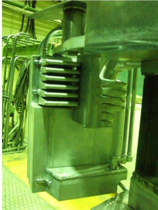
Рис. 83. Фотография изготовленного комбинированного замедлителя для 7, 8, 10 и 11 пучков модернизированной ИЯУ ИБР-2 перед установкой в штатное положение.
