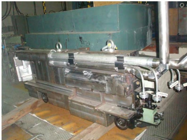
Рис. 84. Фотография тележки с установленным на ней комбинированным замедлителем с трубопроводами подвода и отвода холодного гелия, воды, слива мезитилена, обеспечения вакуума.
