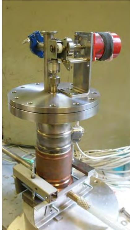
Рис. 97. Дозирующее устройство без вакуумного кожуха на газовом испытательном стенде.
