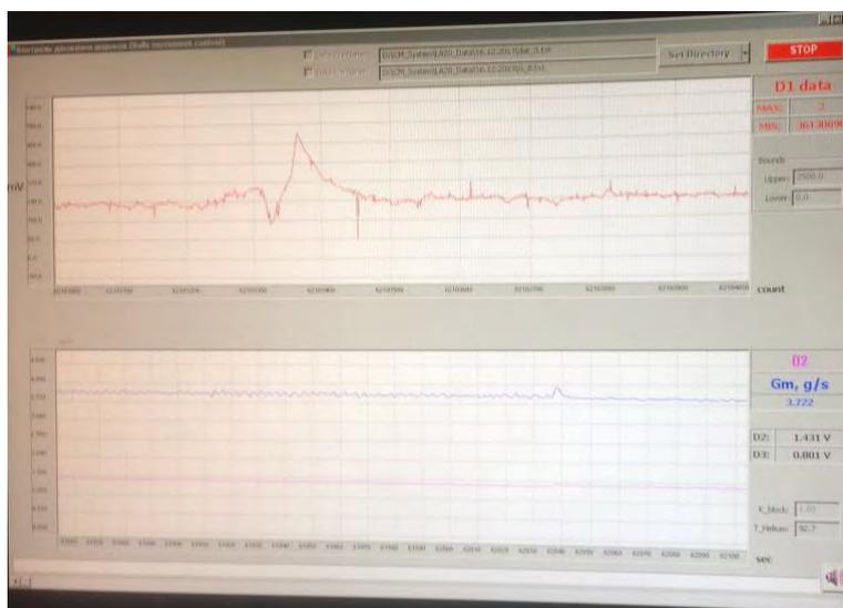
Рис. 107. Рабочее окно программы для визуализации прохождения шариков по системе в процессе загрузки и для визуализации показаний расхода газа.
