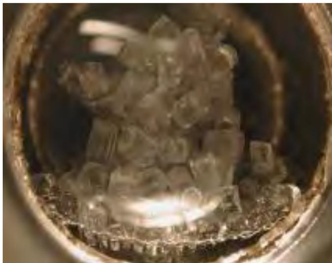
Рис. 22. Гранулы метана с жидким гелием, протекающего через ячейку наблюдения.
