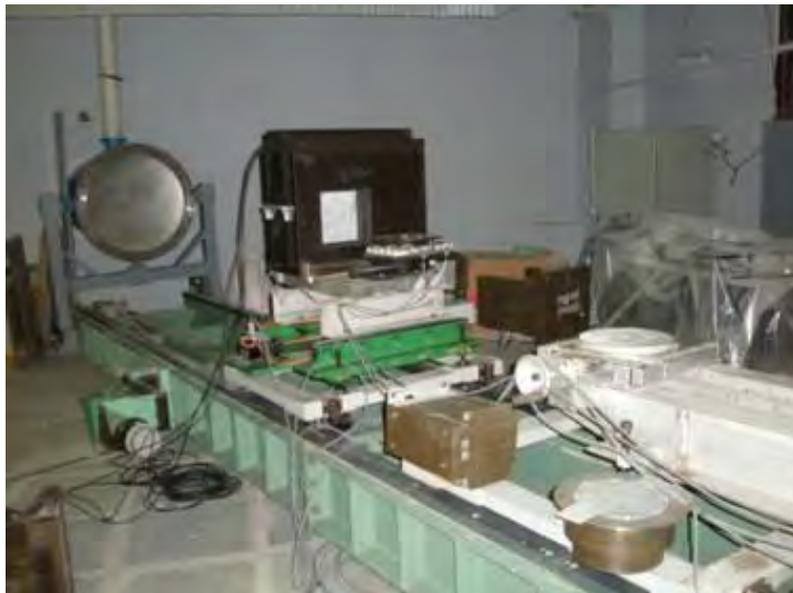
Рис. 110. ПЧД в защите, установленный на 8-м канале ИЯУ ИБР-2.
