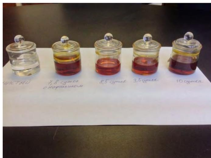
Рис. 114. Изменение цвета слитой смеси мезитилена и м-ксилола после работы холодного замедлителя на ИЯУ ИБР-2 (слева направо: чистая смесь из которой производятся шарики, смесь с нафталином после 7,8 суток облучения шариков, чистая смесь после облучения шариков 8,5 суток, чистая смесь после облучения шариков 9,5 суток, чистая смесь после облучения шариков 10 суток)
