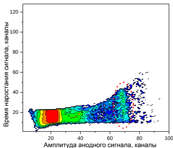
Рисунок 11 - Двухмерный спектр с осями амплитуда анодного сигнала – время нарастания сигнала, полученный после удаления фоновых событий, полученный для изотопа никеля -60 при энергии нейтронов 6,5 МэВ.
