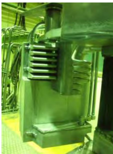
Рис. 18 Фотография изготовленного комбинированного замедлителя для 7, 8, 10 и 11 пучков модернизированной ИЯУ ИБР-2 перед установкой в штатное положение.
