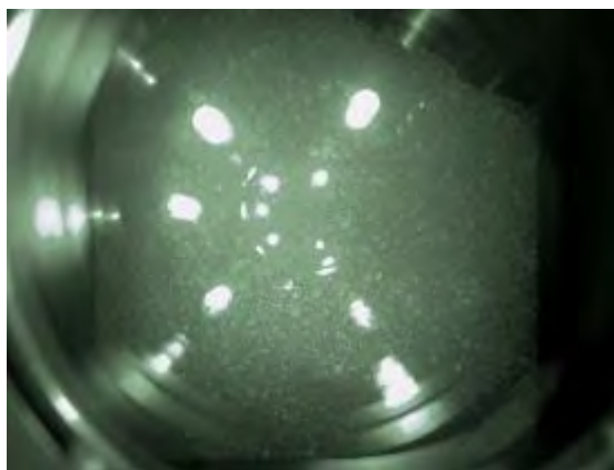
Рис. 17. Фотография шариков в камере-имитаторе криогенного замедлителя. Температура шариков 60 К, количество ~ 25000 шт.
