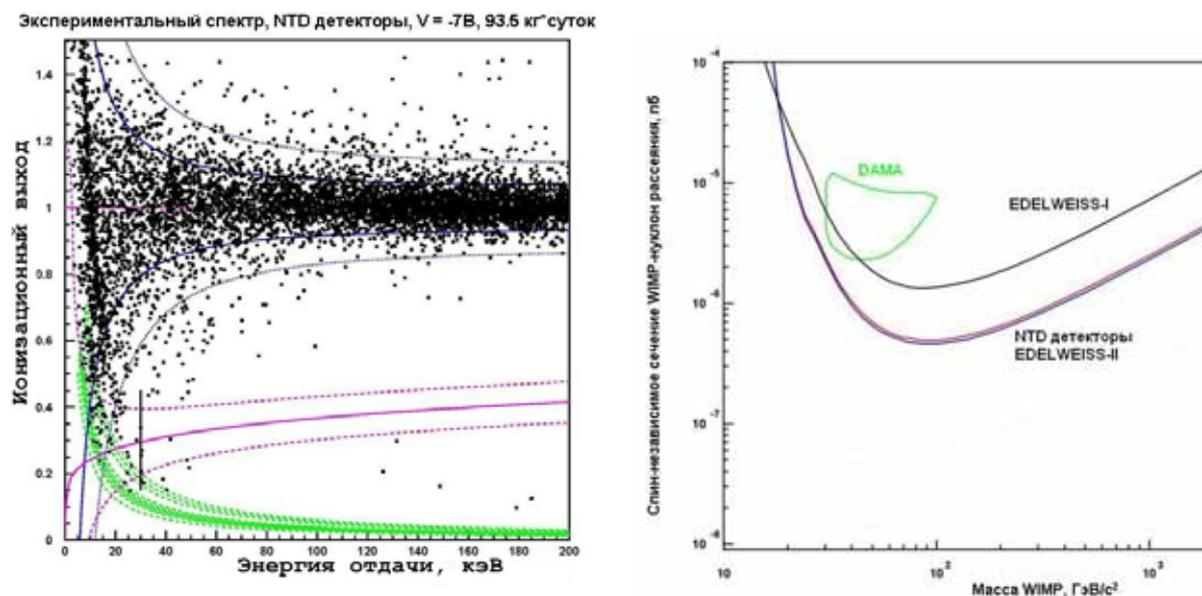
Рис. 4. Экспериментальный спектр, полученный в измерениях с NTD детекторами (слева) и полученное ограничение на спин-независимое сечение WIMP-нуклон рассеяния (справа).
