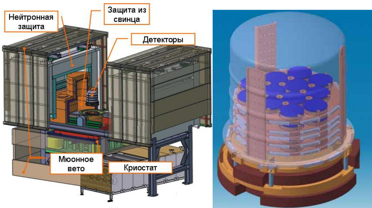
*Рис. 1. Схема защиты от фона, применяемая в эксперименте EDELWEISS. Слева показаны все части установки, включая криостат растворения с детекторами и активную и пассивную защиты; справа показана верхняя часть криостата с детекторами.*
