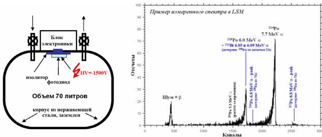
Рис. 2. Схема радонового детектора и полученный энергетический спектр.
