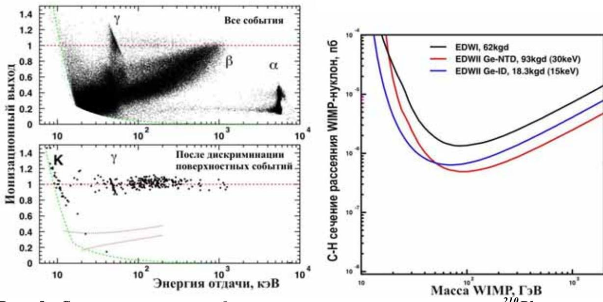
Рис. 5. Слева показаны калибровочные измерения с источником  $^{210}\text{Pb}$  с помощью INTERDIGIT детектора. Демонстрируется устранение фоновых событий после выделения внутреннего объема детектора. Справа представлено ограничение на спин-независимое сечение рассеяния WIMP-нуклон, полученное из измерений с детекторами этого типа.
