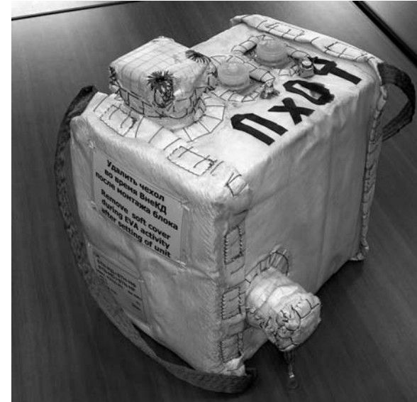
Рис 1. Детекторный блок БТН-МД и монтажная ферма БТН-МФ в сборе в электровакуумной термоизоляции
