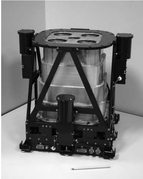
Рис. 3. Общий вид нейтронного телескопа ЛЕНД для космического аппарата НАСА «Лунный разведывательный орбитер» (лётный образец прибора)
