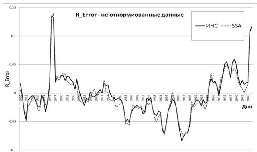
Рис. 41: Зависимости относительных ошибок от порядкового номера дня при прогнозировании с помощью ИНС (сплошная линия) и методом “Гусеница”-SSA (пунктирная линия) для данных, не преобразованных к интервалу [-1,+1]
