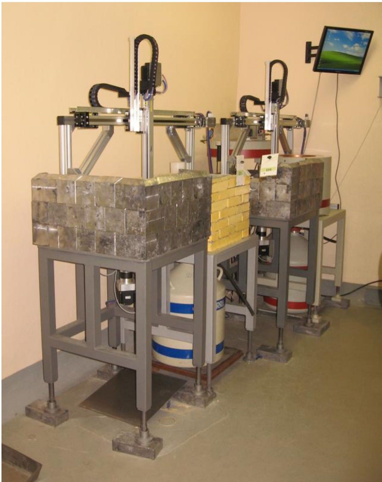
Рисунок 4. Общий вид устройств автоматической смены образцов
