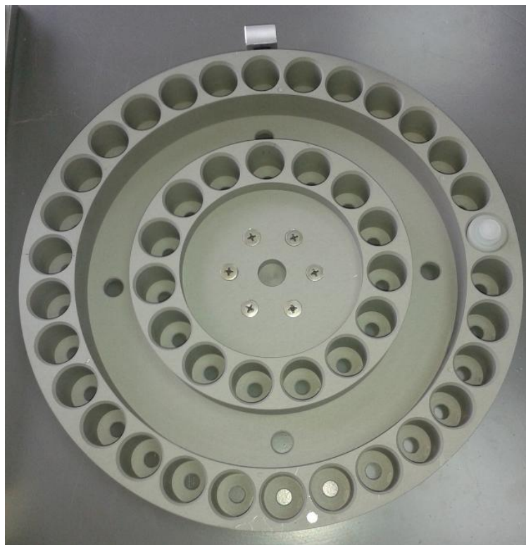
Рисунок 6. Диск для размещения образцов и датчик первой ячейки
