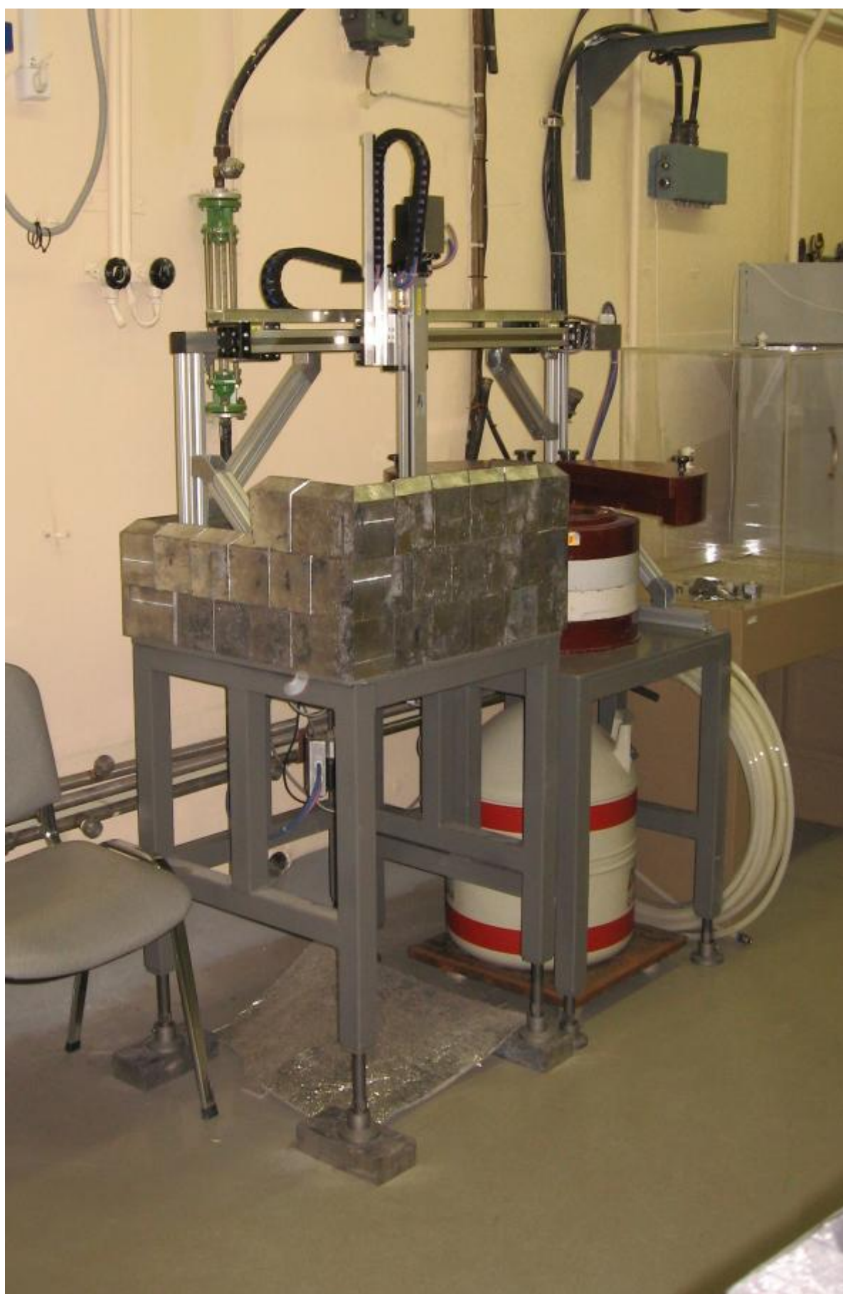
Рисунок 5. Общий вид устройства автоматической смены образцов
