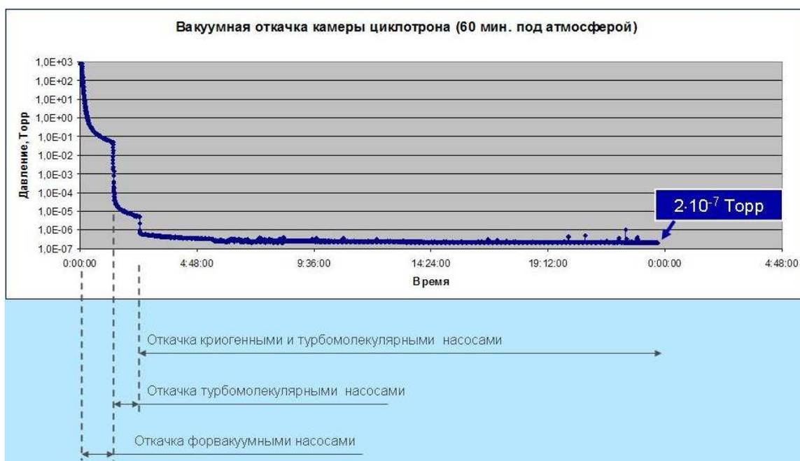
Рис. 5.36. Зависимость давления от времени при откачке вакуумной камеры циклотрона от атмосферы до рабочего вакуума.
