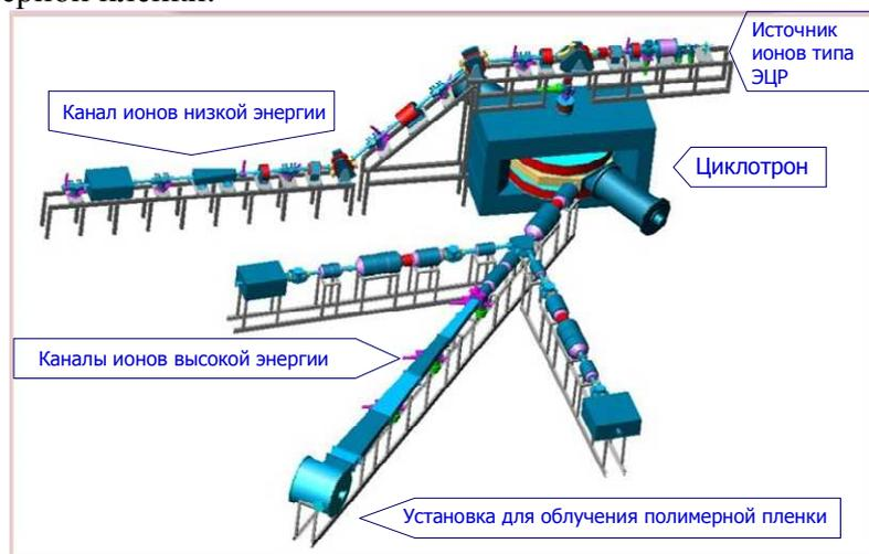
Рис. 2.1. Типичная схема циклотрона тяжелых ионов для прикладных задач.
