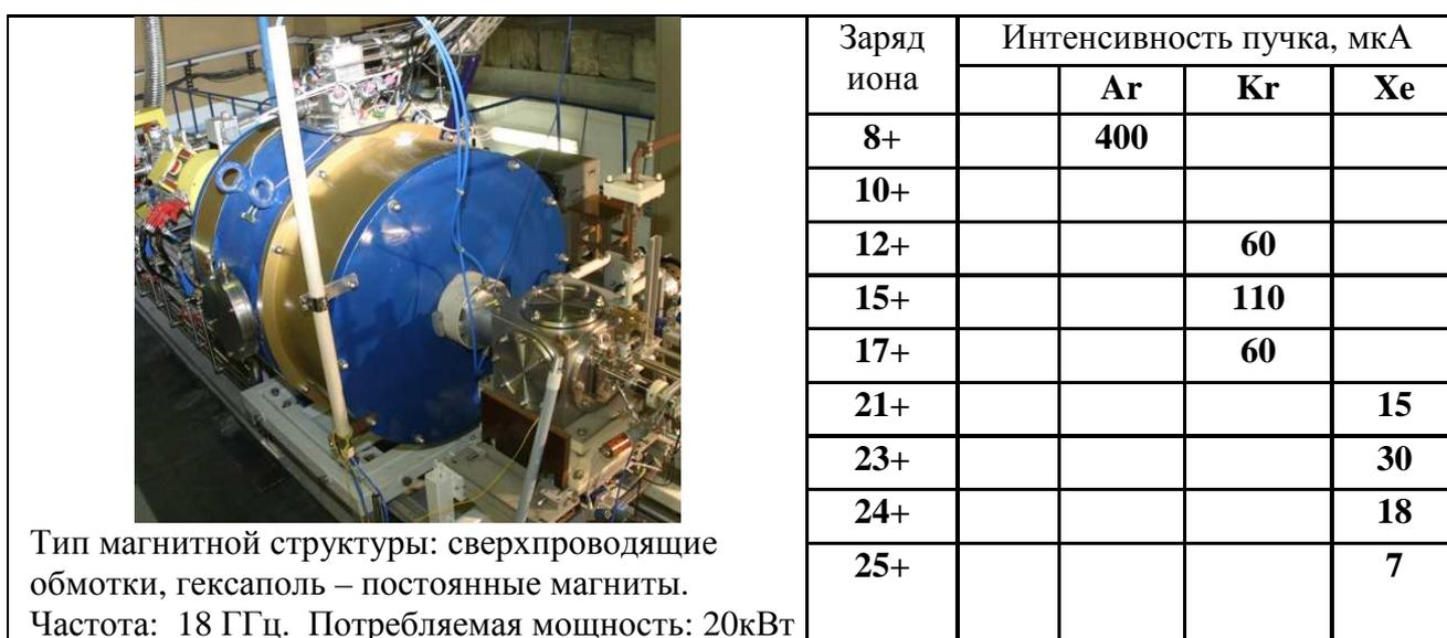
Рис. 2.10. Параметры пучков ионного источника **DECRIС-SC**.
