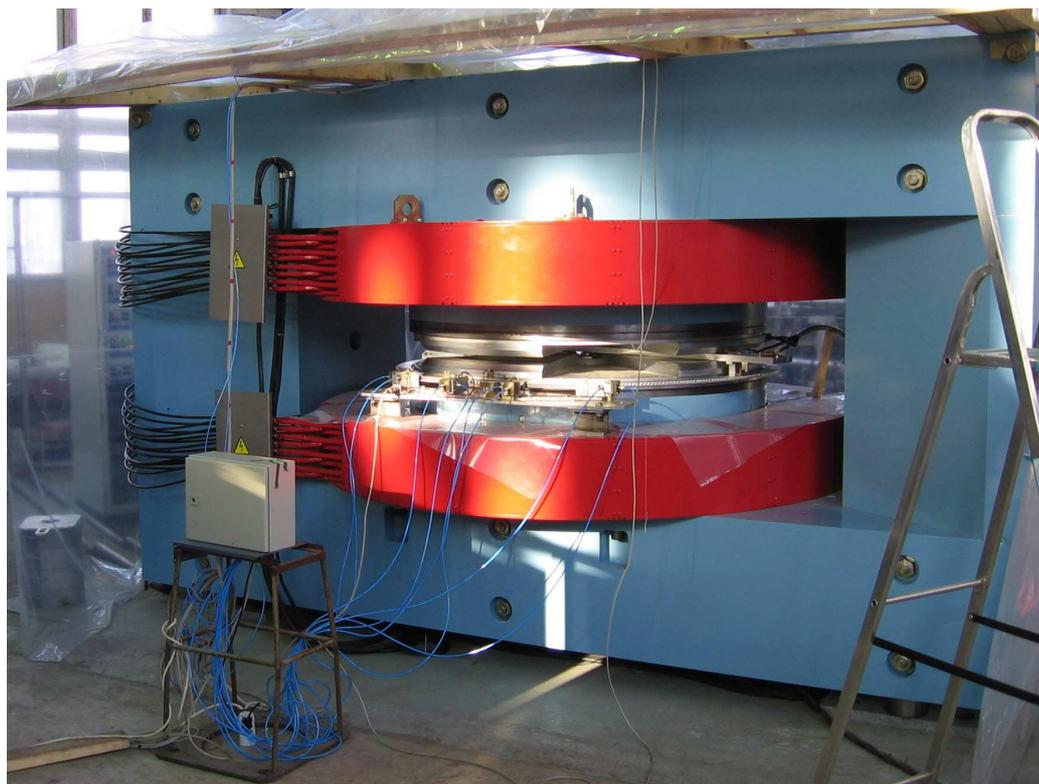
Рис. 4.25. Электромагнит циклотрона ДЦ-60 на испытательном стенде ОИЯИ.
