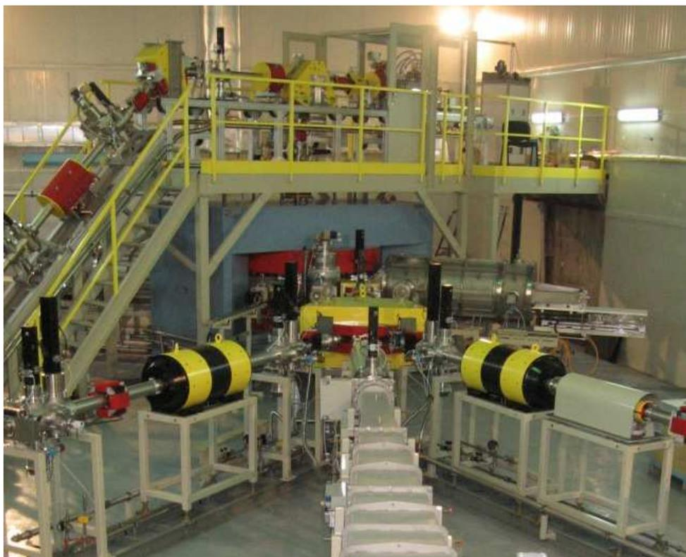
Рис. 4.2. Циклотрон ДЦ-60. Вверху – линия инжекции, ЭЦР источник. Внизу – линии разводки пучков и канал трековых мембран. Вверху слева – канал низких энергий.
