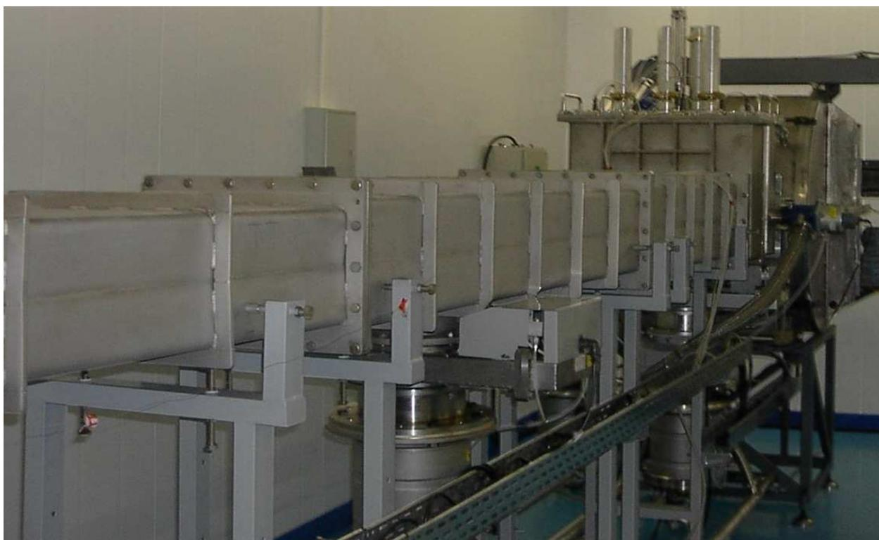
Рис. 3.30. Канал транспортировки пучка к установке для облучения полимерных пленок.
