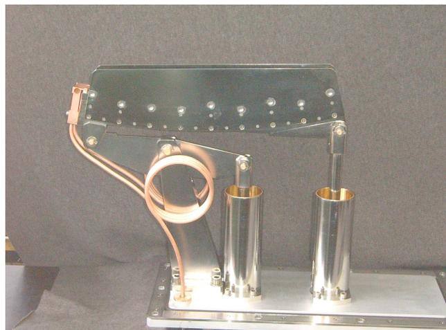
Рис. 4.56. Внешний вид фокусирующего магнитного канала
