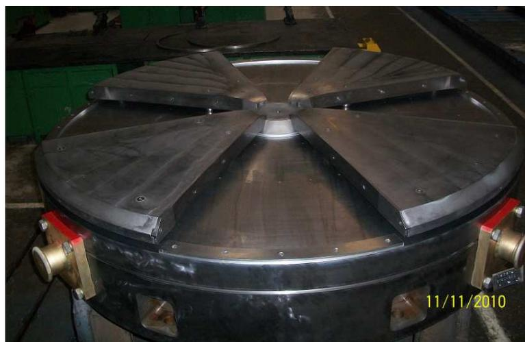
Рис. 5.9. Схема расположения основного фокусирующего (Mch1) и компенсирующего (Mch2) каналов и фотография полюса магнита.
