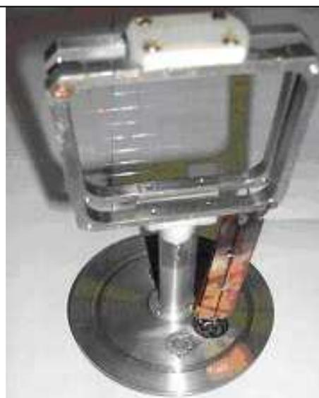
Рис.4.10. Одноззорный банчер циклотрона ДЦ-60.
