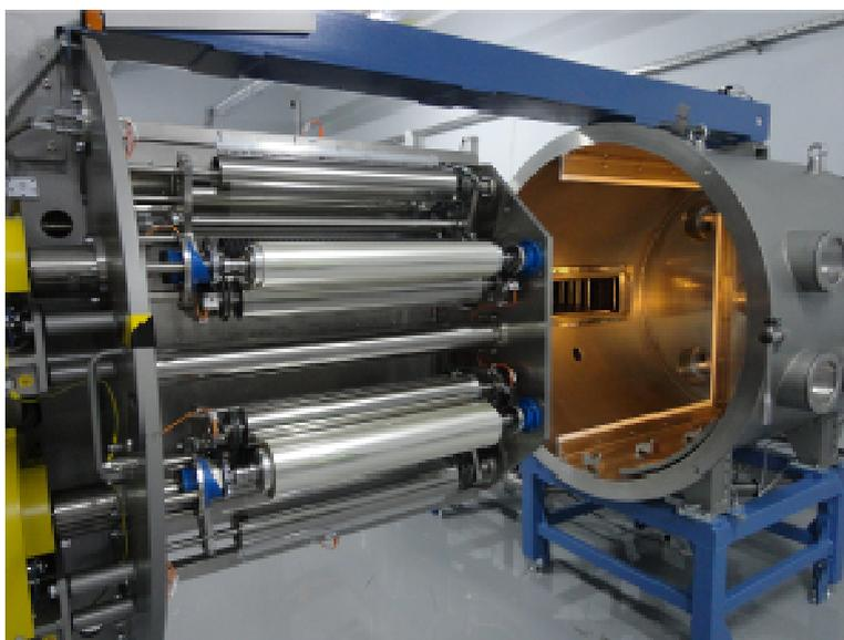
Рис. 5.27. Канал транспортировки пучка и установка для облучения полимерной пленки.
