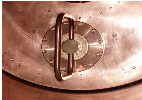
Рис. 2.61. Расположение триммера точной подстройки циклотрона ДЦ-60 на закорачивающей пластине.
