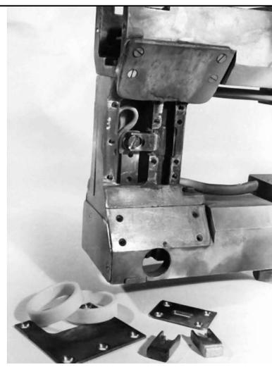
Рис.1.2.Источник ионов типа PIG циклотрона У-400
