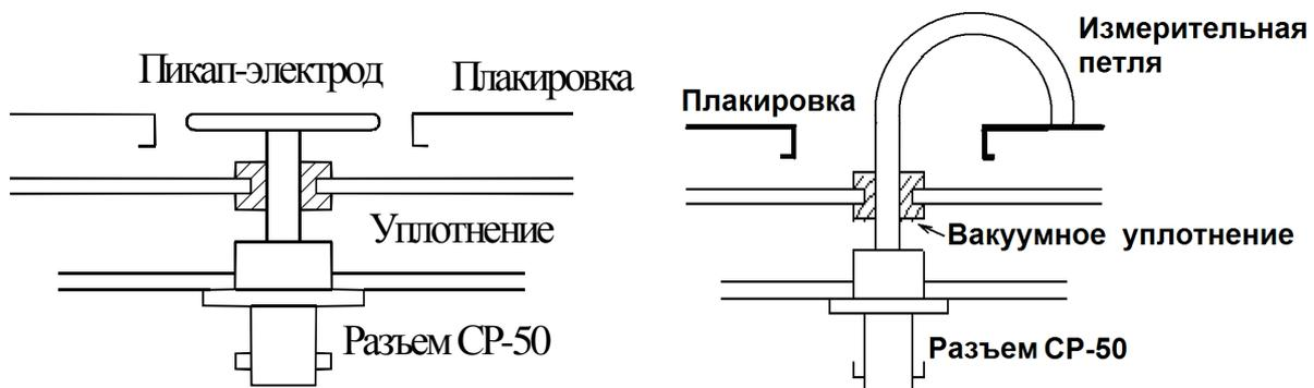
Рис. 2.62. Схема пикап электрода и измерительной петли для диагностики ВЧ параметров резонатора.
