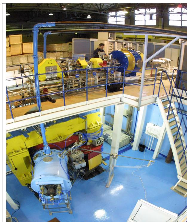
Рис. 3.3. Фото циклотрона ИЦ-100. Вверху – линия инжекции, сверхпроводящий ЭЦР источник. Внизу – магнит циклотрона, резонансный бак №1.
