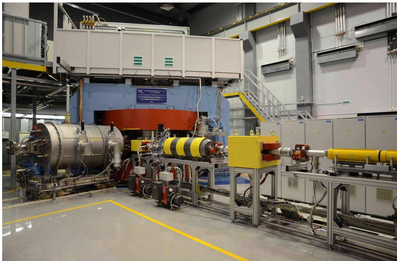
Рис.5.26. Циклотрон ДЦ-110 и канал транспортировки пучка ускоренных ионов.
