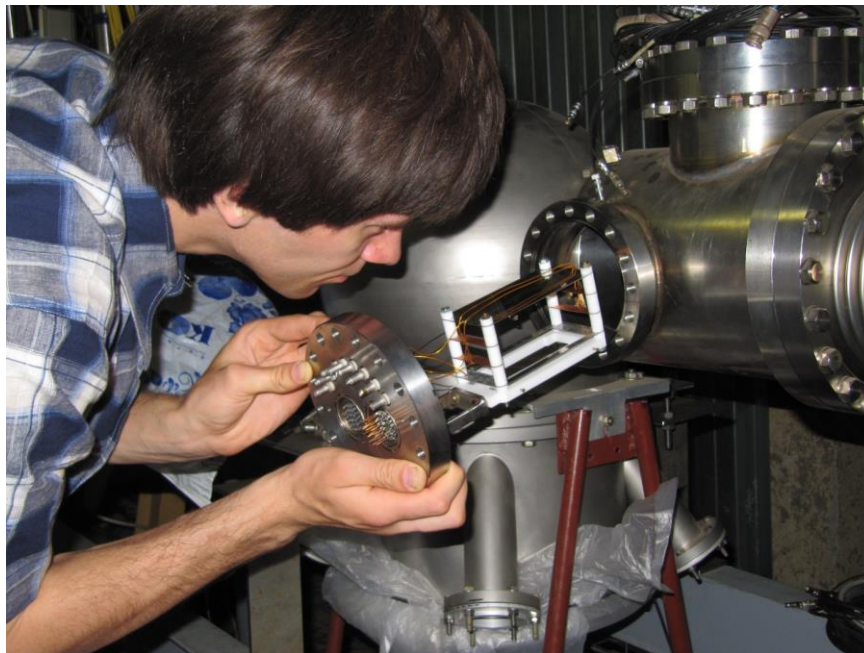
Рисунок 2.8 – Фотография монтажа детектора на «теплом» участке Нуклотрона.
