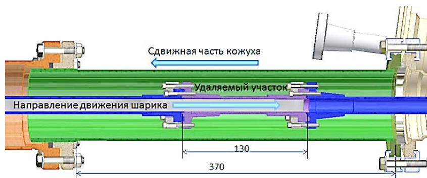
Рисунок 4. Рабочая модель криогенного фланцевого соединения для шарикового замедлителя нейтронов.
