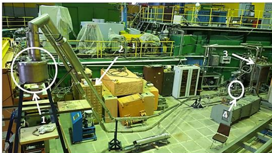
Рисунок 5. Полномасштабный стенд комбинированного замедлителя КЗ 201 в масштабе 1:1, где 1 – камера-имитатор в вакуумном кожухе, 2 – наклонный участок, повторяющий проход в блоке биологической защиты, 3 – теплообменник с двумя газодувками, 4 – устройство порционной подачи шариков.
