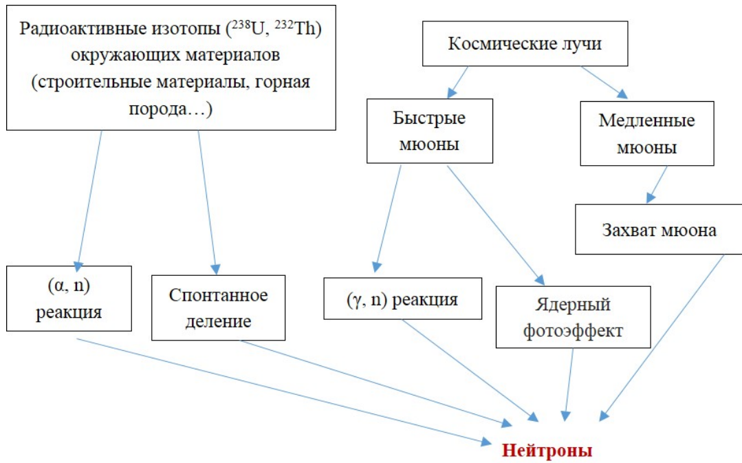
Рис. 4.1. Источники нейтронного фона в подземной лаборатории.
