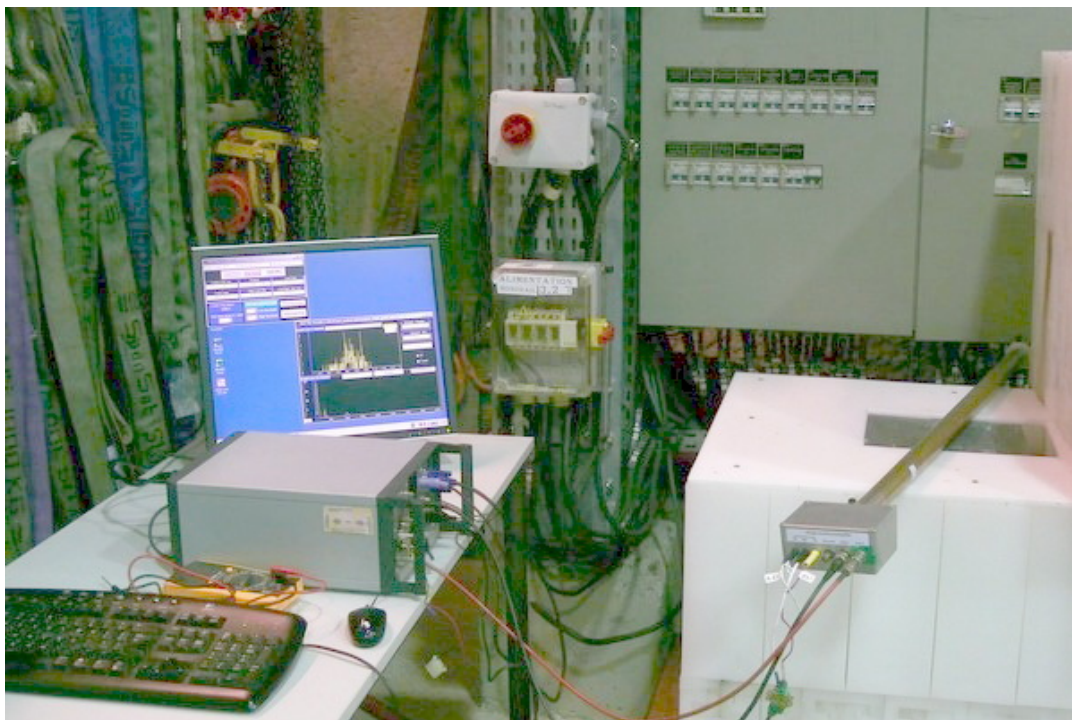
Рис. 4.3. Система измерения потока тепловых нейтронов в лаборатории LSM. Детектор расположен на полиэтиленовой конструкции (правая часть фотографии). Электроника, предназначенная для набора данных, расположена в компактном крейте, стоящем на столе (левая часть фотографии).
