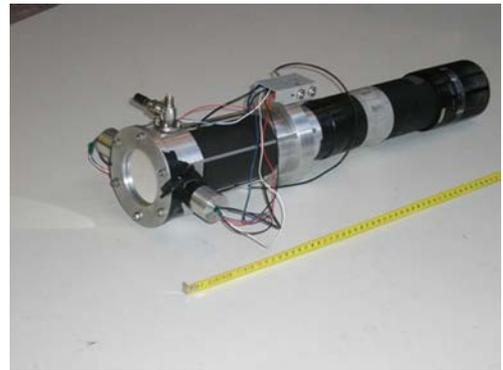
Рис. 12 — Конструкция газовой мишени с ФЭУ
