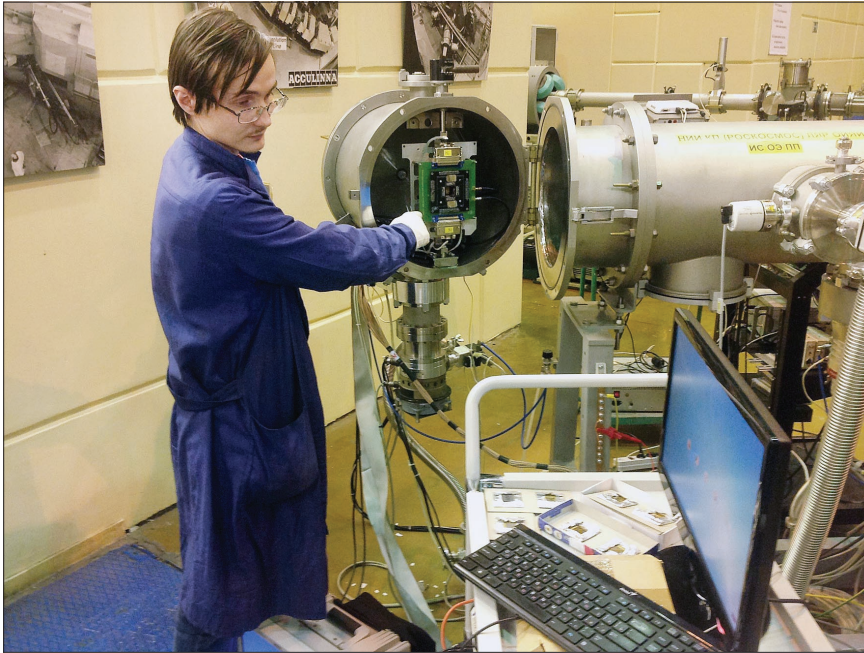
Младший научный сотрудник А. Г. Князев на стенде испытаний электронной компонентной базы циклотрона У-400М.
