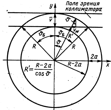
Рис. 12. Геометрия коллиматора вблизи электронно-ионного кольца
