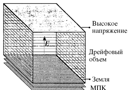
Рис.6. Схематическое изображение ВПК прямоугольной формы
