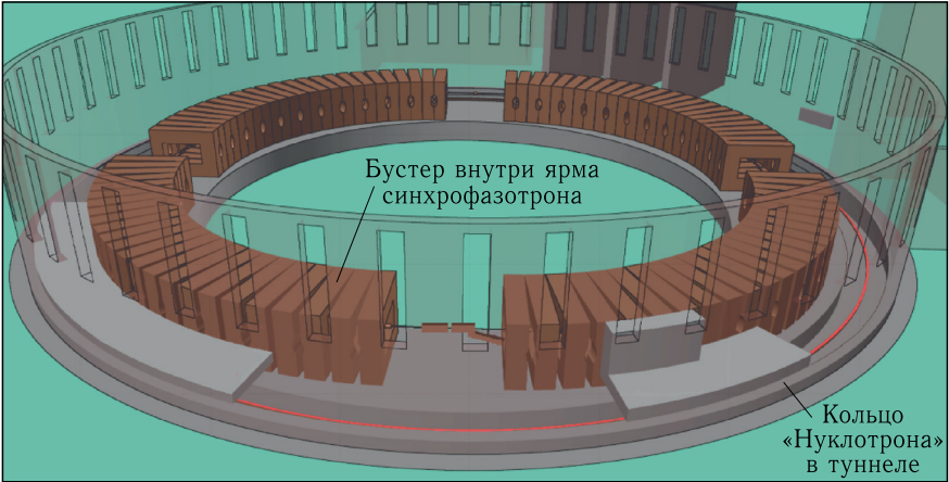
Рис. 61. Геометрия бустера и «Нуклотрона» внутри здания № 1
