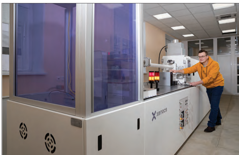
Рентгеновская установка Xeuss 3.0, позволяющая проводить исследования наночастиц с помощью рентгеновского малоуглового рассеяния и изучать кристаллическую структуру методом рентгеновской дифракции
