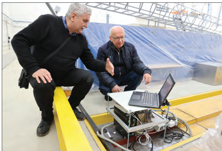
Лаборатория физики высоких энергий им. В. И. Векслера и А. М. Балдина. Установка двух малогабаритных лазерных инклинометров в экспериментальном зале MPD NICA
