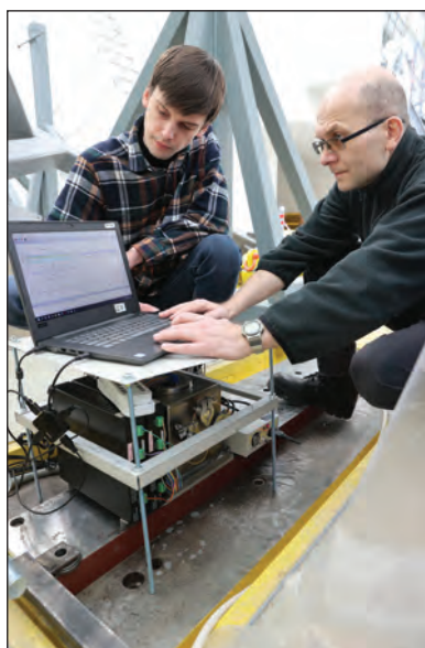
Лаборатория физики высоких энергий им. В. И. Векслера и А. М. Балдина. Установка двух малогабаритных лазерных инклинометров в экспериментальном зале MPD NICA
