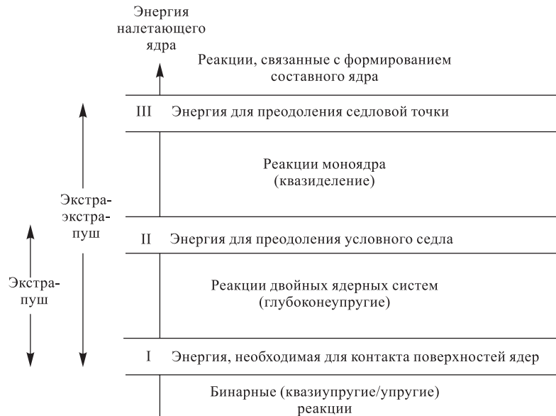
Рис. 12. Схема, иллюстрирующая энергетические пороги различных ядерных процессов, реализующихся в столкновениях двух массивных ядер [57]
