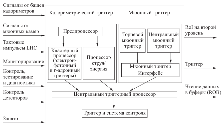
Рис. 6. Блок-схема триггерной системы первого уровня установки ATLAS
