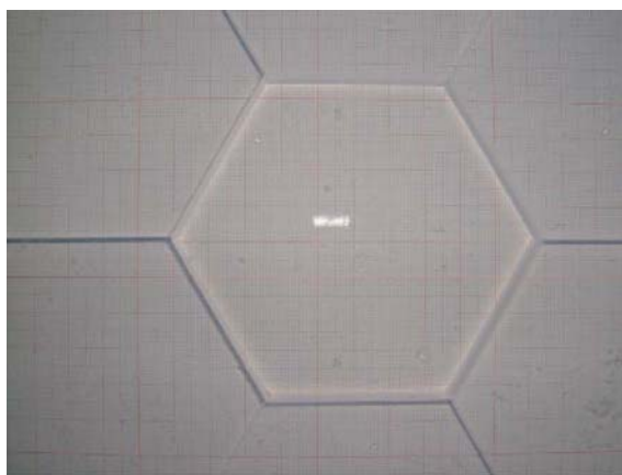
Рис. 4. Слой радиатора, составленный из семи аэрогельных пластин шестиугольной формы с n = 1,050 [15]
