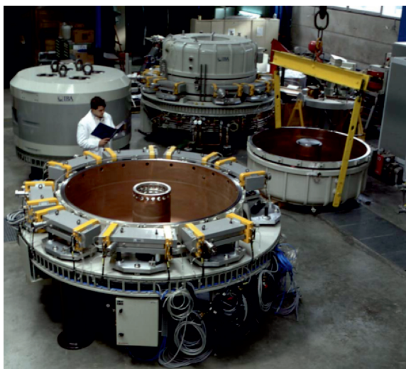
Рис. 18. Сборка магнитов родотрона (из [59])
