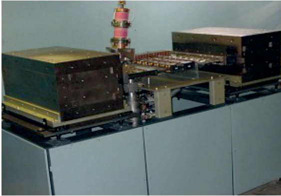
Рис. 5. 14-оборотный рейс-трековый микротрон МГУ (из [43])
