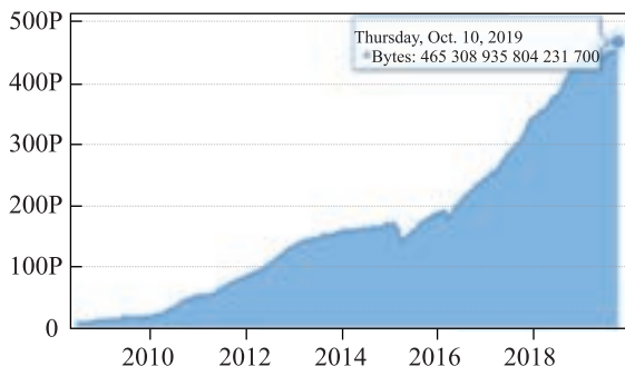
Рис. 41. Объем управляемых данных эксперимента ATLAS
