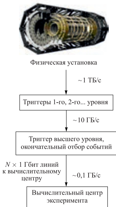
Рис. 3. Поток данных физического эксперимента
