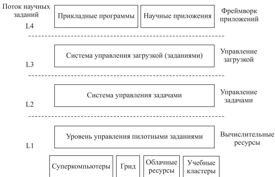
Рис. 31. Схема интеграции системы управления загрузкой и вычислительных мощностей
