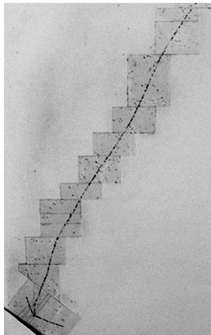
Рис. 1. Титульная страница отчета ФИАИ (слева) и извилистый след  $\pi^-$ -мезона, захваченного ядром эмульсии с образованием двух фрагментов (справа) (предоставлено С. П. Харламовым)
