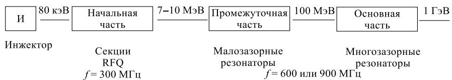
Рис. 2. Структурная схема сильноточного линейного ускорителя протонов
