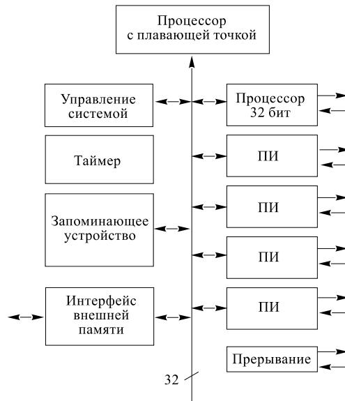
Рис. 22. Блок-схема типичного транспьютера. В одном кристалле содержится процессор с плавающей точкой и второй процессор с RISK-архитектурой, оперативной памятью. Наряду с каналом прямого доступа к памяти имеется четыре последовательных дуплексных канала обмена (ПИ — последовательный интерфейс)
