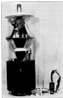
Рис.9. Многоэлементные детекторы из InSb (1) и PbSe (2) с блоками предусилителей и системами охлаждения
