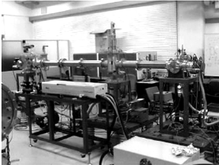
Рис. 3. Установка с Nd-YAG-лазером с энергией в импульсе 2,3 Дж и длительностью импульса 6–8 нс [7]
