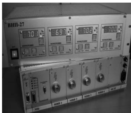
Рис. 1. Источник питания ВИП-27
