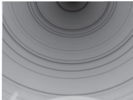
Рис. 7. Дифрактограмма корунда при рассеянии «назад». Детектор — Image Plate (IP); размер пучка на образце — 1 \times 1 мм; длина волны СИ — 1,30 \text{ \AA} ; экспозиция — 980 \text{ мА} \cdot \text{мин} ; расстояние образец–детектор — 180 \text{ мм}
