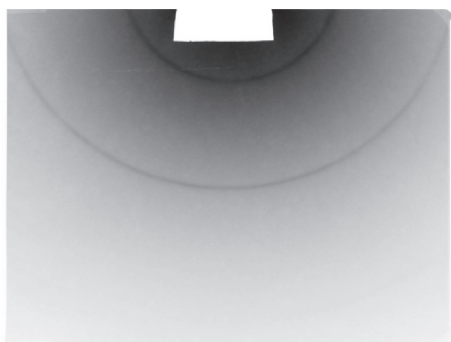
Рис. 6. Дифрактограмма корунда при рассеянии «вперед». Детектор — Image Plate (IP); размер пучка на образце — 1 \times 1 мм; длина волны СИ — 1,30 \text{ \AA} ; экспозиция — 640 \text{ мА} \cdot \text{мин} ; расстояние образец–детектор — 225 \text{ мм}
