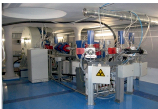
Рис. 3. Циклотрон СС-18/9М с удаленными мишенями
