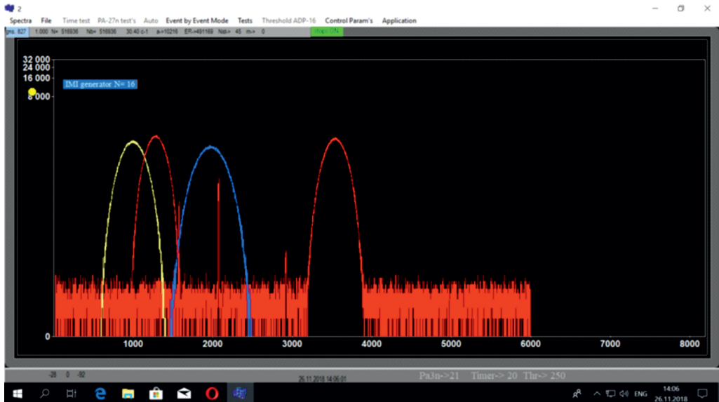
Рис. 6. Спектры, генерируемые программой с привязкой к сигналам генератора. Показаны (слева направо) сгенерированные спектры \Delta E_{1,2} , TOF, ER. Узкие пики соответствуют сигналам \alpha -распада. Также показаны фоновые отсчеты (равномерное распределение)
