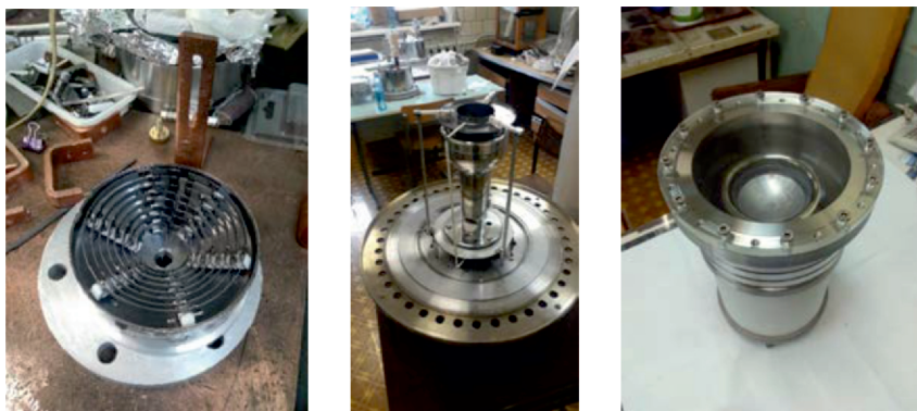
Рис. 4. Катодный узел клистрона. Слева направо: спираль накала, катодная «нога» на стенде тестирования эмиссии катода, катодный узел в сборке
