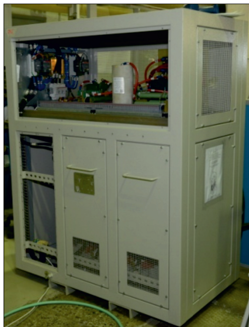
Рис. 4. Стойка высоковольтного питания
