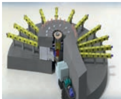
Рис. 11. Схема вывода на ИБР-4 нейтронных пучков № 2
