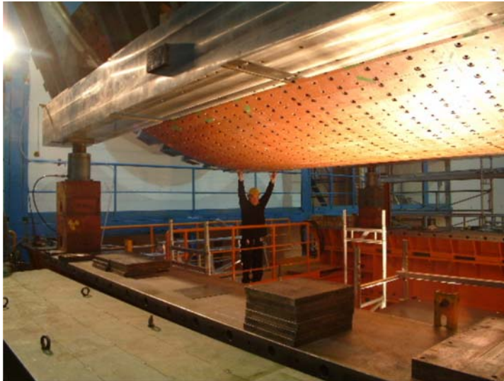
Рис. 5. Уникальный момент: технологическое основание из-под барреля извлечено. На четырех домкратах стоят седла, удерживающие вместе 18 модулей общей массой 262 т
