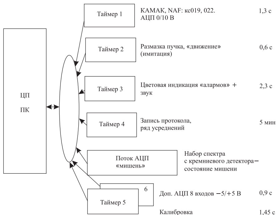
Рис. 3. Блок-схема системы контроля параметров
