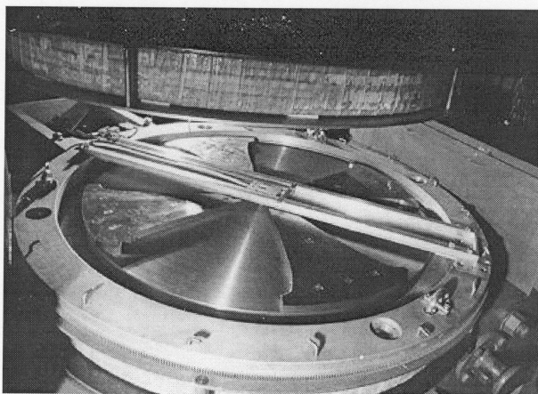
Рис. 9. Нижний полюс модели магнитной системы с измерительной штангой
