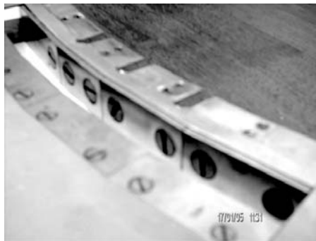
Рис. 21. Магнитный канал №2, состоящий из четырех секций с различным градиентом при прохождении пучка в магнитном поле с азимутальной вариацией на границе между сектором и долиной
