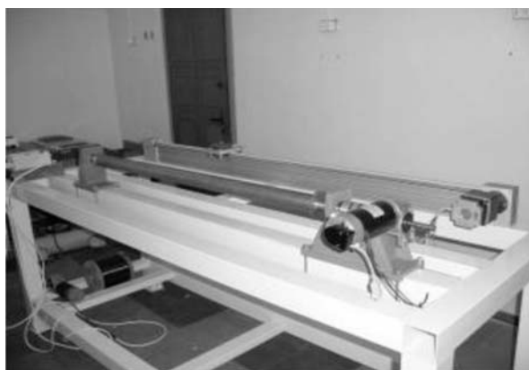
Рис. 1. а) Криогенная камера и вакуумная система нового источника «Крион-6Т» в сборе; б) автоматическое намоточное устройство для изготовления сверхпроводящего соленоида
