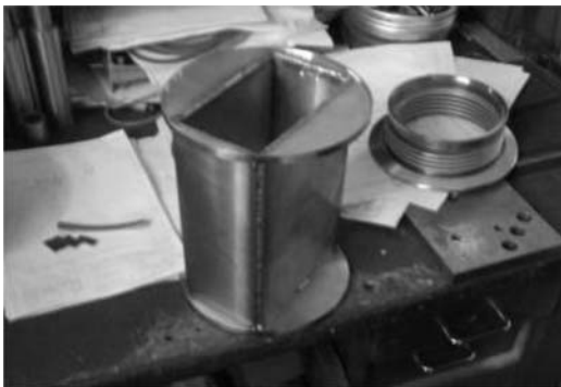
Рис. 10. Новая пикап-станция в процессе сборки в опытном производстве ЛФВЭ
