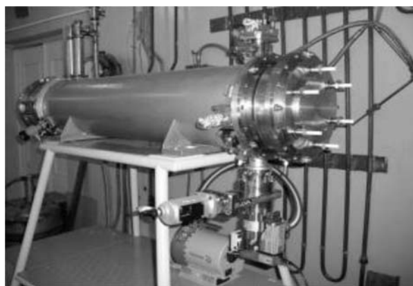
Рис. 1. а) Криогенная камера и вакуумная система нового источника «Крион-6Т» в сборе; б) автоматическое намоточное устройство для изготовления сверхпроводящего соленоида
