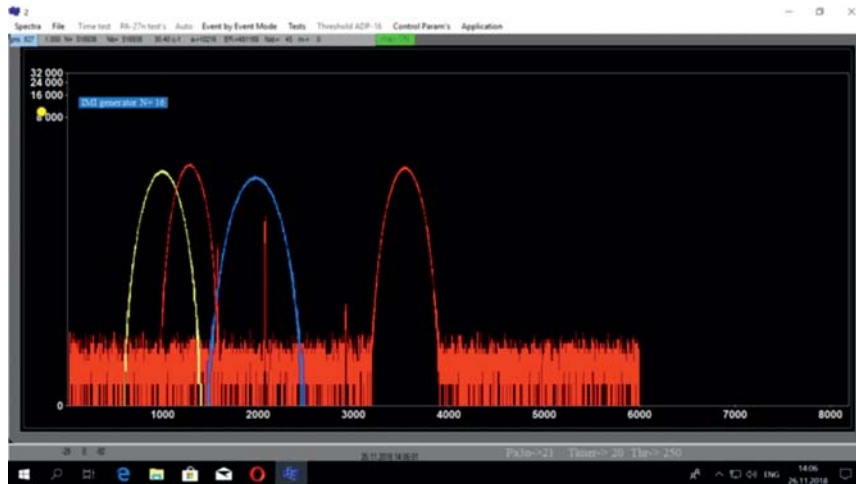
Рис. 6. Спектры, генерируемые программой с привязкой к сигналам генератора. Показаны (слева направо) сгенерированные спектры \Delta E_{1,2} , TOF, ER. Узкие пики соответствуют сигналам \alpha -распада. Также показаны фоновые отсчеты (равномерное распределение)
