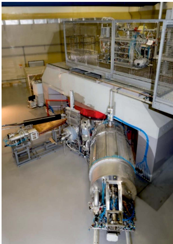
Базовая установка фабрики СТЭ — циклотрон ДЦ-280
