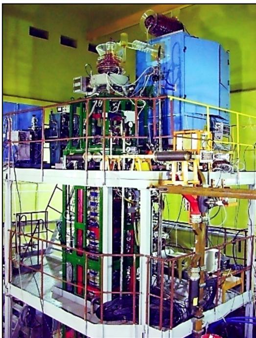
Рис. 21. Общий вид первой очереди ускорителя ЛУЭ-200
