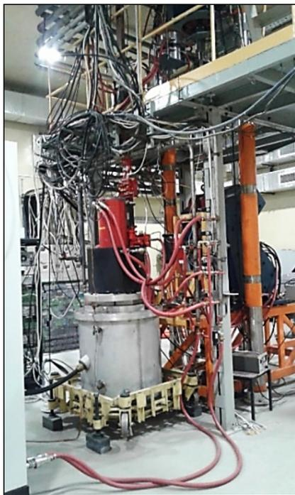
Рис. 27. Вторая очередь ЛУЭ-200. Вид нижней части ускорителя
