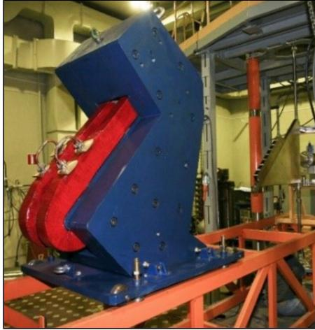
Рис. 18. Магнит спектрометра, установленный на ускорителе
