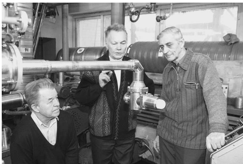
Лаборатория высоких энергий им. В. И. Векслера и А. М. Балдина. Жидководородная мишень для проекта «Термализация», изготовленная в криогенном отделе ЛВЭ. Слева направо: Ю. Т. Борзунов, В. А. Никитин, Л. Б. Голованов
