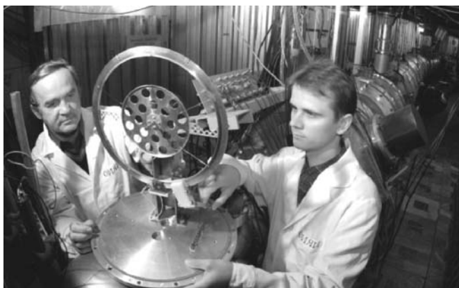
Лаборатория высоких энергий им. В. И. Векслера и А. М. Балдина. Общий вид механизма станции внутренних мишеней нуклотрона перед установкой в вакуумную камеру ускорителя
