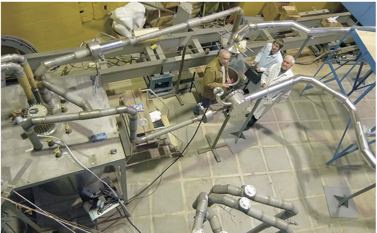
ЛНФ. Полномасштабный стенд для испытаний нового криогенного замедлителя реактора ИБР-2М
