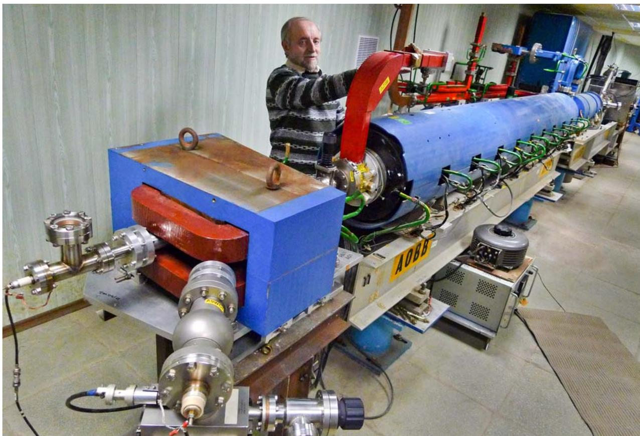
Лаборатория ядерных проблем им. В. П. Джелепова. Первая ускоряющая секция ускорителя электронов ЛИНАК-800
